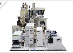
On-line LC-MS-NMR system
